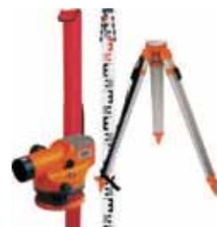
X-Nivelliere sind hochwertige Baunivelliere, die höchsten Ansprüchen gerecht werden. Die besonders lichtstarke Optik mit großem Objektivdurchmesser, der robuste, luftgedämpfte Kompensator und die solide Verarbeitung zeichnen diese Baunivelliere aus, daher für extrem harte Einsatzbedingungen bestens geeignet. kontrastreiches Bild, Prüfprotokoll, komplett mit Senklot, Justiernadel und stabilem Transportkoffer.
